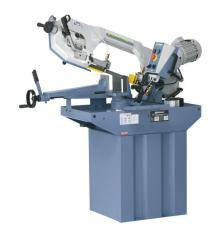
Das Modell HBS 275 ist eine präzise Horizontalbandsäge für den universellen Einsatz. Merkmale dieser Maschine sind der Hydraulikzylinder zum feinfühligem Absenken des Sägebügels sowie ein Manometer für die Bandspannungsanzeige.
