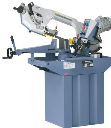
Das Modell HBS 275 ist eine präzise Horizontalbandsäge für den universellen Einsatz. Merkmale dieser Maschine sind der Hydraulikzylinder zum feinfühligen Absenken des Sägebügels sowie ein Manometer für die Bandspannungsanzeige.
