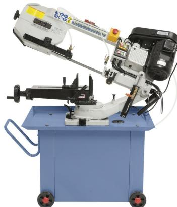
Die Doppelgehrenbandsäge GBS 200 B mit dem schwenkbaren Sägebügel ermöglicht ein platzsparendes Arbeiten, da die Position des Materials bei Gehrungsschnitten nicht verändert werden muss. Durch den optimalen Schnittbereich und den 4 einstellbaren Schnittgeschwindigkeiten ist dieses Modell ideal für den Profiheimwerker.
