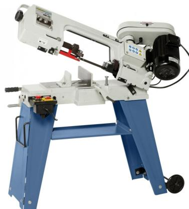
Tausendfach bewährte Kombibandsäge zum Vertikal- und Horizontalschneiden. Durch die vielseitigen Einsatzmöglichkeiten und dem äußerst attraktivem Preis-Leistungsverhältnis ist dieses Modell ideal für Bastler und Profiheimwerker.
