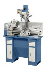
Das Bearbeitungszentrum Proficenter 550 WQV lässt für Feinmechaniker, Ausbildungs- und Lehrwerkstätten, usw. keine Wünsche offen. Bohren, Fräsen und Drehen auf kleinstem Raum, serienmäßig mit digitaler Anzeige für Bohrtiefe und Drehzahl zum komfortablen Arbeiten, sowie eine große Spindelbohrung, alles kombiniert in einer Maschine.
