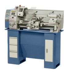
Die Drehmaschine Profi 700 Top ist unser neues Modell, die serienmäßig mit einem hochwertigen Delta-Frequenzumrichter ausgestattet ist. Wesentliche Vorteile, die sich daraus ergeben, sind das hohe Drehmoment im unteren Drehzahlbereich und die annähernd konstante Drehzahl unter Last.
