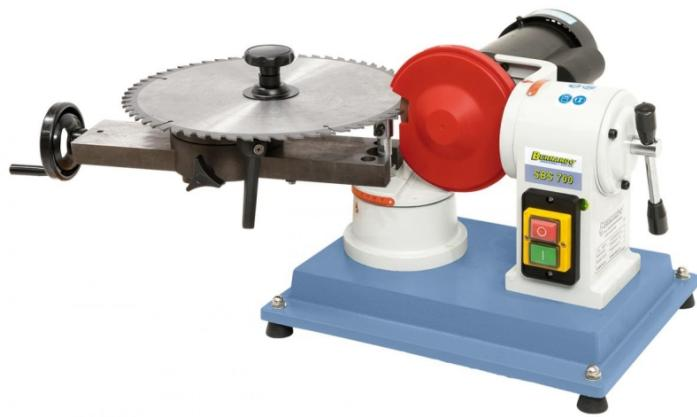
Die robuste Sägeblatt-Schärfmaschine SBS 700 dient zum Schärfen von hartmetallbestückten und CV-Sägeblättern mit einem Durchmesser von 80 - 700 mm. Durch die schwenkbare Motor-Schleifscheibeneinheit bzw. Sägeblatthalterung können die verschiedensten Verzahnungen geschliffen werden.
