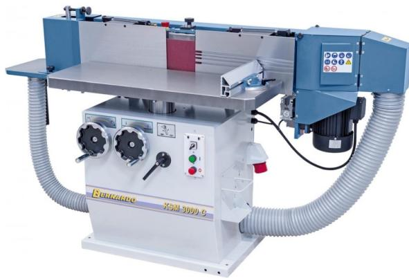
Die schwere Kantenschleifmaschine KSM 3000 C ist serienmäßig mit einer Furnierkantenschleifeinrichtung ausgestattet, wodurch ein sekundenschnelles Umstellen von Furnierkanter- auf Massivholzschliff möglich ist. Ihren Einsatz findet diese Maschine vorwiegend beim anspruchsvollen Handwerker und in Industriebetrieben.
