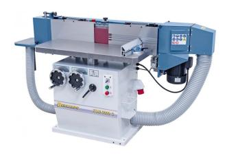
Die schwere Kantenschleifmaschine KSM 3000 C ist serienmäßig mit einer Furnierkantenschleifeinrichtung ausgestattet, wodurch ein sekundenschnelles Umstellen von Furnierkanten- auf Massivholzschliff möglich ist. Ihren Einsatz findet diese Maschine vorwiegend beim anspruchsvollen Handwerker und in Industriebetrieben.
