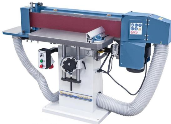
Die Kantenschleifmaschine KSM 2600 C ist serienmäßig mit einer Schleifband-Oszillation mit separatem Getriebemotor ausgestattet. Das von 90° bis 45° schnellverstellbare Schleifaggregat ermöglicht das Schleifen von geraden und schrägen Kanten.
