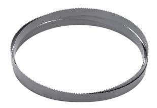
Das Bernardo Sägeband BiFlex 3660 x 34 x 0,9 - Vario 4/6 ZpZ Sägebänder Metallbandsägen ist ein hochwertiges Sägeband für Metallbandsägen. Es ist aus BiFlex-Material gefertigt und bietet eine Abmessung von 3660 x 34 x 0,9 mm. Das Sägeband ist mit einer Zahnung von Vario 4/6 ZpZ ausgestattet.
