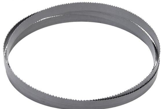
Das Bernardo Sägeband BiFlex 1638 x 13 x 0,6 - Vario 6/10 ZpZ Sägebänder Metallbandsägen ist ein hochwertiges Sägeband für Metallbandsägen. Die Abmessungen betragen 1638 x 13 x 0,6 mm. Das Sägeband ist aus dem Material BiFlex gefertigt und verfügt über eine variable Zahnung von 6/10 Zähnen pro Zoll.
