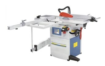
Die Formatkreissäge FKS 1250 N erfüllt die Anforderungen professioneller Anwender wie Präzision, hoher Bedienkomfort, schnelle Umrüstung und Vielseitigkeit. Merkmale dieses Modells sind die hochwertige Verarbeitung, der leichtgängige Formatschiebetisch sowie der Längsanschlag mit Rundstangenführung und Feineinstellung.
