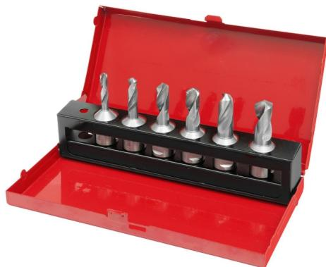
Vollbohrer eignen sich bestens für Kernbohrmaschinen zum Bohren kleinerer Durchmesser (6 – 13 mm). Die wesentlichen Vorteile gegenüber Spiralbohrern sind die höhere Stabilität durch die Weldon-Direktaufnahme und dass durch die zwei Schneiden kein Ankönnen erforderlich ist.
