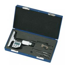
Die Bernardo Digital-Tiefenmessschraube 0 - 100 mm ist eine präzise Messschraube für verschiedene Anwendungen. Die Messschraube bietet einen Messbereich von 0 - 100 mm und eine Genauigkeit von 0,001 mm. Die Messnadeln sind vierfach ausgeführt.
