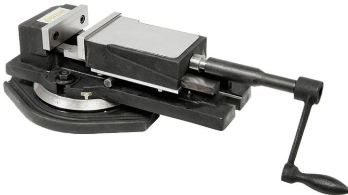
**Bernardo Weitspann-Maschinenschraubstock FJ 100 Schraubstöcke** bieten eine extrem große Spannweite und eine lange Flachbahnhöhung der beweglichen Spannweite. Die Führungsteile und Spannbacken sind gehärtet und geschliffen, die Spindel ist schmutz- und spänegeschützt. Das mechanische Spannsystem ist komplett mit Drehsteller und 360°-Skala.
