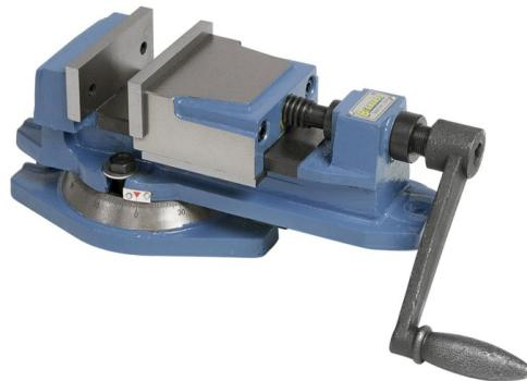
**Bernardo Maschinenschraubstock KV 100 Schraubstöcke** ist ein robuster Schraubstock für Frä-, Hobel- und Bohrmaschinen. Der Schraubstockkörper ist aus hochwertigem Guss hergestellt. Die Führungsteile und Spannbacken sind gehärtet und geschliffen.
