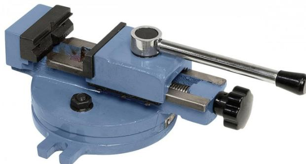
Der Bernardo Schnellspannschraubstock SP 55 ist ein Schraubstock mit einer Backenbreite von 55 mm und einer Backenhöhe von 20 mm. Die maximale Öffnungsweite beträgt 60 mm. Der Schraubstock wiegt etwa 2,8 kg.
