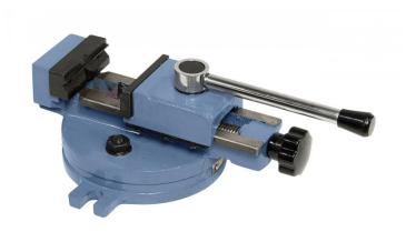
Der Bernardo Schnellspannschraubstock SP 55 ist ein Schraubstock mit einer Backenbreite von 55 mm und einer Backenhöhe von 20 mm. Die maximale Öffnungsweite beträgt 60 mm. Der Schraubstock wiegt etwa 2,8 kg.
