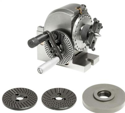
Der Bernardo Halbuniversal-Teilkopf BS-0 Zubehör Rundtische ist ein hochpräzises Werkzeug für verschiedene Anwendungen. Die Spindel ist in Präzisionskegelrollenlagern gelagert, die Schnecke besteht aus Chrom-Nickel-Stahl und ist gehärtet sowie geschliffen. Das Phosphor-Bronze-Schneckenrad und die Übersetzung, die ausrastbar zum direkten Teilen ist (40:1), ermöglichen eine präzise und effiziente Arbeit.
