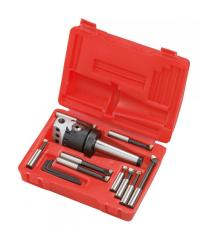
Der Bernardo Plan- und Ausdrehkopfset mit einem Durchmesser von 75 mm und Aufnahme MK 4 ist ideal für verschiedene Anwendungen. Die Feinverstellung ermöglicht eine präzise Einstellung von 0,01 mm pro Teilstrich.
