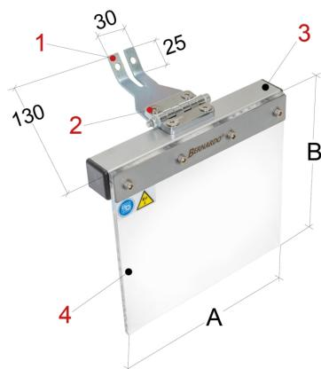
Die Bernardo Schutzeinrichtung für Schleifmaschinen PMA-S Größe 2 ist eine einteilige Schutzeinrichtung zur Montage auf Bandschleifmaschinen, Doppelschleifmaschinen oder ähnlichen Maschinen. Sie schützt den Bediener vor wegfliegenden Funken und Schleifstaub. Diese Schutzeinrichtung verfügt über ein feststellbares Drehgelenk für schnelle Einstellung und einem großen Schutzglas aus schlagfestem Kunststoffmaterial.
