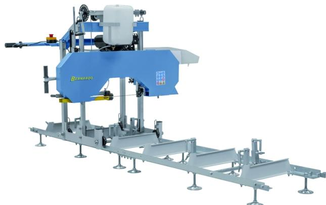
Die Blockbandsägen der BBS-Serie sind wahlweise mit Elektroantrieb bzw. Benzinmotor erhältlich. Die Elektro-Variante wird hauptsächlich stationär eingesetzt, das benzinbetriebene Modell eignet sich ideal für den mobilen Einsatz. Auf Grund des guten Preis-Leistungs-Verhältnisses sind diese Maschinen ideal für Landwirte, Waldbesitzer, Zimmereien usw.
