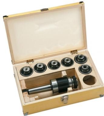
Der Bernardo Gewindeschneidapparat MK 2 / M3 - M12 ist ein hochpräzises Werkzeug für das maschinelle Gewindeschneiden. Es eignet sich für Durchgangs- und Grundlochgewinden (Sacklöcher) und ist kompatibel mit Handvorschub für Kern-, Tisch- und Säulenbohrmaschinen.
