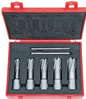
Die HM-Kernbohrer mit hochwertiger Hartmetallbeschichtung und optimierter Schneidengeometrie gewährleisten eine hohe Standzeit und hervorragende Zerspanleistung von schwer zerspanbaren Werkstoffen wie z.B. Chrom-Nickelstahl, aber auch bei NE-Materialien, Aluminium, Baustahl,.... Die Sets beinhalten die meistgebrauchten Größen mit einer Bohrtiefe von 35 mm.
