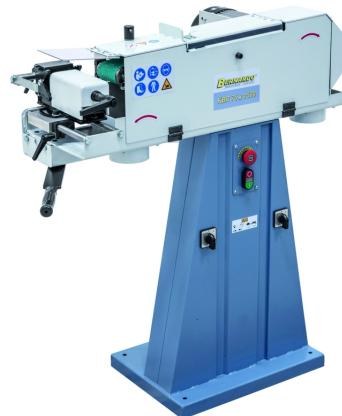
Die KBR 75 x 1500 ist eine multifunktionelle Schleifmaschine zum Rohr- und Profilendenschleifen an der Vorderseite, zum Schleifen von Kanten, Flächen und zum Rundschleifen an der Rückseite sowie zum Planschleifen auf er Maschinenoberseite.
