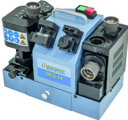
Die Bohrer- und Schaftfräzerschleifmaschine DEG 14 ermöglicht das Schleifen von Spiralbohrern und Schaftfräsern - kombiniert in einer Maschine. Durch den einstellbaren Spitzenwinkel ist diese Maschine universell einsetzbar und für verschiedenste Bohrer und Schaftfräser geeignet.
