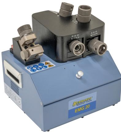
Die Schaftfräzerschleifmaschine EMG 20 ist ideal zum Schleifen von Schaftfräsern aus HSS und Hartmetall. Durch den einstellbaren Spitzenwinkel von 0° bis 5° ist dieses Modell universell einsetzbar für 2-, 3- und 4-schneidige Fräser.
