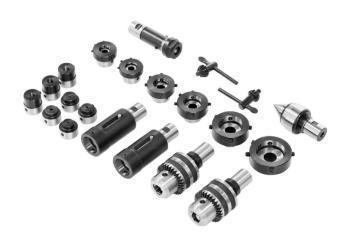
Der Bernardo Einsätze für Revolverkopf MK 4 ist ein Spannmittel für Werkzeuge. Dieses Produkt umfasst verschiedene Komponenten, um eine effiziente Werkzeugspannung zu ermöglichen.
