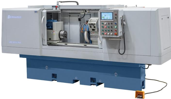
Die Universal-Rundschleifmaschine URS 32100 PLC eignet sich zur Ausführung von Außenrundschleifarbeiten für Werkstücke bis 320 mm Durchmesser, durch die serienmäßige Innenschleifeinrichtung wird der Anwendungsbereich zusätzlich erweitert. Ihren Einsatzbereich findet dieses Modell hauptsächlich im Maschinenbau, im Formen- und Werkzeugbau, aber auch bei der Kleinserienfertigung in der Produktion.
