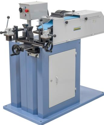
Die KBR 150 x 2000 ist eine multifunktionelle Schleifmaschine zum Rohr- und Profilendenschleifen an der Vorderseite sowie zum Planschleifen auf der Maschinenoberseite. Durch den leistungsstarken Antriebsmotor sowie der robusten Bauweise ist dieses Modell optimal für den professionellen Einsatz in Werkstätten und bei der Produktion von Kleinserien.
