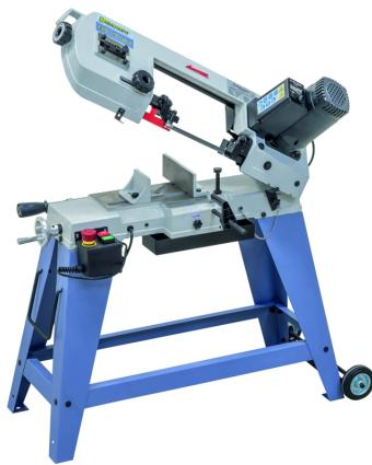
Die Vario-Metallbandsäge EBS 115 Vario ist serienmäßig mit einer variablen Schnittgeschwindigkeit ausgestattet, dadurch wird eine optimale Anpassung an verschiedenste Materialien ermöglicht. Durch die vielseitigen Einsatzmöglichkeiten und dem äußerst attraktivem Preis-Leistungsverhältnis ist dieses Modell ideal für Bastler und Profiheimwerker.
