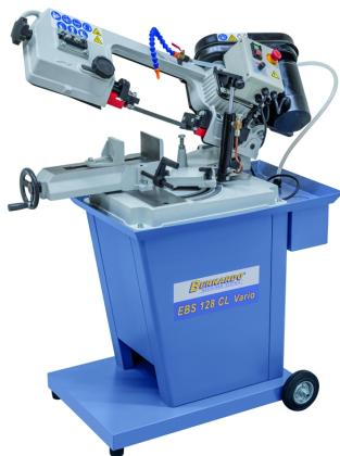
Die Doppelgehrungsbandsäge EBS 128 CL Vario ist serienmäßig mit einer variablen Schnittgeschwindigkeit ausgestattet, dadurch wird eine optimale Anpassung an verschiedenste Materialien ermöglicht. Der Sägebügel ist bis 60° schwenkbar, dadurch ermöglicht dieses Modell ein platzsparendes Arbeiten bei langen Werkstücken.
