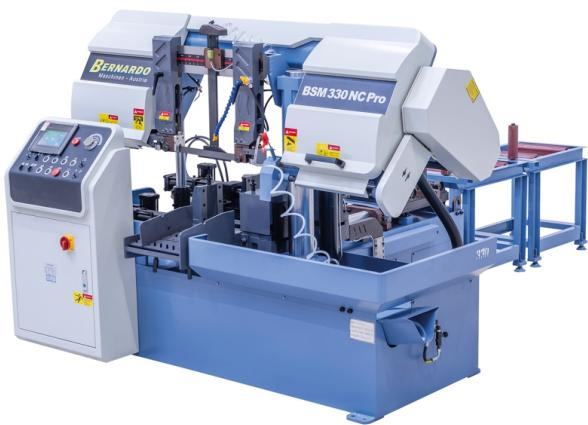
Das Modell BSM ist eine vollautomatische Metallbandsäge mit dem wesentlichen Vorteil, dass die Zustellung des Sägerahmens über eine präzisionsgeschliffene Doppelsäulenführung erfolgt. Dadurch eignet sich diese Maschine ideal zum Bearbeiten von Blöcken aus Vollmaterial. Zusätzlich ist dieses Modell mit einer hydraulischen Bündelspanneinrichtung zum Schneiden von Materialpaketen ausgestattet.
