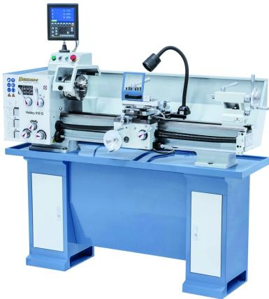
Die Drehmaschine Hobby 910 G ist serienmäßig mit einer Leitspindel zum Gewindeschneiden bzw. für den automatischen Längs- und Planvorschub ausgestattet. Durch das 12-Stufen-Schaltgetriebe wird ein schnelles Einstellen der Drehzahlen ermöglicht - kein Keilriemenwechsel notwendig. Durch ihre kompakte Bauweise und das hohe Eigengewicht bietet diese Maschine eine hohe Laufruhe und garantiert dadurch präzises Arbeiten.
