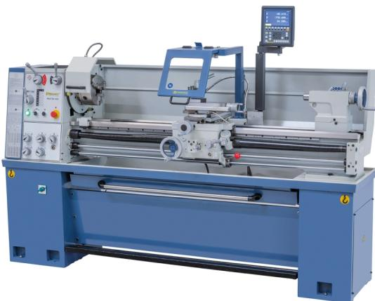
Die Master 400 ist eine kompakt gebaute Universaldrehmaschine mit großem Einsatzbereich und überzeugt vor allem durch den Drehdurchmesser von 400 mm, sowie der Spindelbohrung von 52 mm. Aufgrund ihrer Konstruktion (Bauart, Leistung, Vorschübe,...) kann sie sowohl in Ausbildungswerkstätten, aber auch für den Werkzeugbau und Reparaturbetriebe erfolgreich eingesetzt werden.
