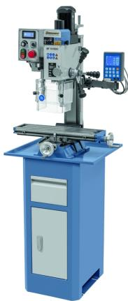
Die Bohr- und Fräsmaschine BF 18 BDC ist serienmäßig mit einem hochwertigem Gleichstrommotor ausgestattet. Wesentliche Vorteile, die sich daraus ergeben, sind das hohe Drehmoment im unteren Drehzahlbereich und die annähernd konstante Drehzahl unter Last. Ihren Einsatzbereich findet dieses Modell hauptsächlich beim professionellen Anwender, im Modellbau, aber auch im Ausbildungsbereich.
