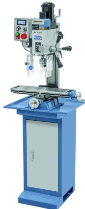
Die Bohr- und Fräsmaschine BF 18 BDC ist serienmäßig mit einem hochwertigem Gleichstrommotor ausgestattet. Wesentliche Vorteile, die sich daraus ergeben, sind das hohe Drehmoment im unteren Drehzahlbereich und die annähernd konstante Drehzahl unter Last. Ihren Einsatzbereich findet dieses Modell hauptsächlich beim professionellen Anwender, im Modellbau, aber auch im Ausbildungsbereich.
