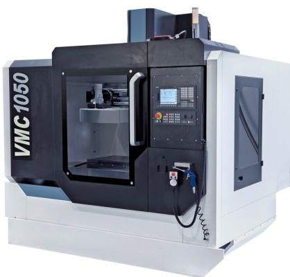
Das CNC-Vertikalarbeitungszentrum VMC 1050 ist wahlweise mit einer Siemens Sinumerik 808D Advanced 16 oder 828D Steuerung und einem 16-fach Werkzeugwechsler ausgestattet. Durch die kompakte Bauweise, einer Tischgröße von 1000 x 500 mm sowie den großen Verfahrwegen ist dieses Modell ideal zur Bearbeitung von kleinen und mittelgroßen Serien in der Produktion, aber auch zur Einzelteilanfertigung im Formen- bzw. Maschinenbau sowie im Ausbildungsbereich wird dieses Modell mit Erfolg eingesetzt.
