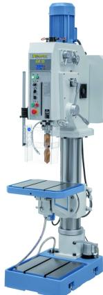
Die Getriebebohrmaschine GB 55 ist serienmäßig mit einem motorischen Tischhub zur Reduzierung der Nebenzeiten ausgestattet. Durch die robuste Ausführung und der großen Leistungsfähigkeit ist dieses Modell sowohl für Reparaturbetriebe als auch für die industrielle Fertigung verwendbar.
