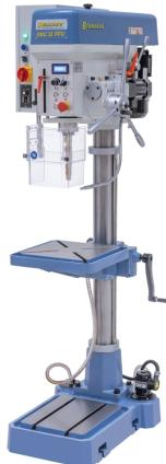
Die Säulenbohrmaschine DMC 35 PFV ist serienmäßig mit einer Gewindeschneideinrichtung sowie einem automatischen Bohrvorschub ausgestattet. Die stufenlose Drehzahlregelung ermöglicht eine optimale Anpassung der Schnittgeschwindigkeit an das Werkstück.
