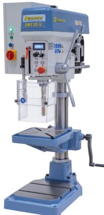
Die Tischbohrmaschine DMT 25 V ist serienmäßig mit einer stufenlosen Drehzahlregelung ausgestattet, wodurch die Schnittgeschwindigkeit optimal an das Werkstück angepasst werden kann. Durch die kompakte Bauweise ist dieses Modell für den allgemeinen Werkstatteneinsatz bestens geeignet.
