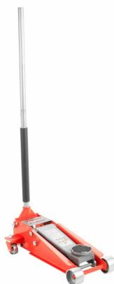
Der HOLZMANN Rangierwagenheber RWH300 ist für das Heben von besonders schweren Fahrzeugen konzipiert. Er ist mit einer Profilgummiauflage am Aufnahmeteller, Schnellhubfunktion (Easy-Lift Funktion), stabilen Gelenkketten für hohe Lebensdauer und Griffen auf beiden Seiten ausgestattet. Das Schließen und Öffnen des Hydraulikventils erfolgt mittels dem geriffelten Handhebel.
