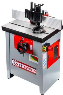
Die HOLZMANN FS160SOLID\_400V kombiniert kompakte Bauweise mit extremer Motorpower. Durch extra Wechselspindel können auch Schafträser eingesetzt werden. Eine kraftvolle Maschine für vielseitige Anwendungen.
