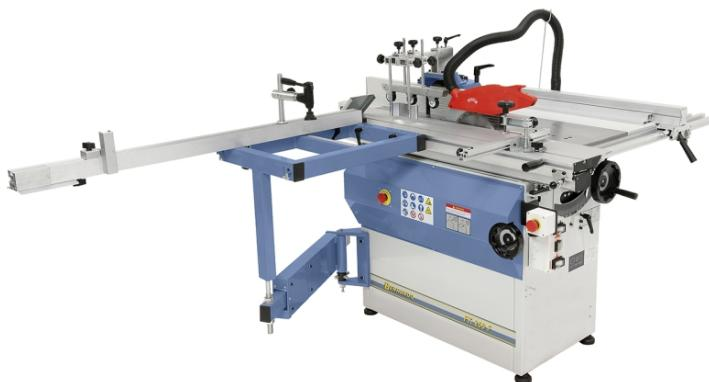
Die Formatkreissäge-Fräsmaschine FK 250 F ist durch den serienmäßigen Formattisch für den ambitionierten Heimwerker ideal geeignet. Dank der umfangreichen Standardausstattung (Vorritzagggregat, 3 Spindeldrehzahlen, Formattisch, ...) wird dem Anwender ein optimales Preis-Leistungsverhältnis geboten.
