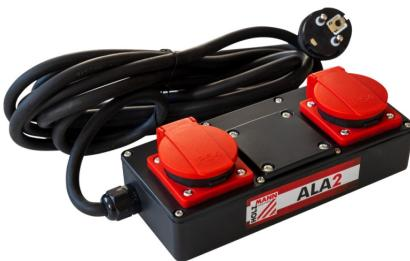
Mit der HOLZMANN Anlaufautomatik für Absauggeräte lässt sich ihre Absaugung nach aktivieren der Holzbearbeitungsmaschine automatisch ein und ausschalten (beide auf 230 V Basis). Die Holzbearbeitungsmaschine und die Absaugung an die Anlaufautomatik anschließen und schon kann es losgehen. (Voraussetzung der Absaugung sollten vorher geprüft werden um einen reibungslosen Betrieb zu gewährleisten).
