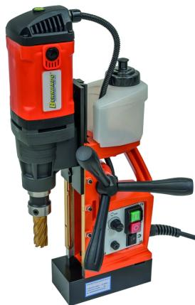
Die Bernardo Magnet-Kernbohrmaschine MD 3550 VD \* ist eine leistungsstarke Maschine für das Kernbohren, Senken, Reiben und andere Anwendungen. Sie verfügt über eine variable Drehzahleinstellung, um die Schnittgeschwindigkeit optimal anzupassen. Die Maschine ist serienmäßig mit einem Sicherheitsriemen für Vertikal- oder Über-Kopf-Anwendungen ausgestattet.
