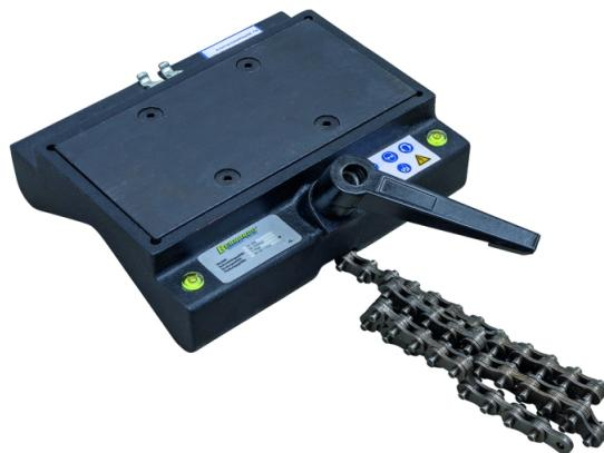
Unsere Rohrspannvorrichtungen für Magnetbohrmaschinen bieten eine zuverlässige und sichere Fixierung auf Rohren und runden Werkstücken während des Bohrvorgangs. Besonders in Anwendungen, bei denen auf nicht-magnetischen oder runden Oberflächen gebohrt wird, garantieren die Vorrichtungen eine stabile Positionierung der Magnetbohrmaschine.
