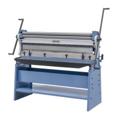
Die Universalmaschine 3 IN 1 - 1320 ist ideal geeignet für Karosseriebauer, Modellbauer und Baustelleneinsatz. Sie bietet verschiedene Biegemöglichkeiten durch herausnehmbare Abkantsegmente und eine automatische Werkstückklemmung beim Schneiden.
