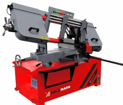
Die HOLZMANN Metallbandsäge BS450TURN\_400V überzeugt durch ihre massive Ausführung und einem kraftvollen Motor mit Riemenantrieb. Die Sägebandgeschwindigkeit lässt sich durch Riemenumlage in vier Stufen einstellen (25|40|51|71 m/min). Mit der großen Schnittleistung von bis zu 380 x 254 mm und dem schwenkbaren Sägearm (Schnitte bis zu 45°) sind anspruchsvolle Anforderungen erfüllbar.
