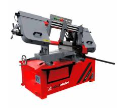
Die HOLZMANN Metallbandsäge BS450TURN überzeugt durch ihre massive Ausführung und einem kraftvollen Motor mit Riemenantrieb. Die Sägebandgeschwindigkeit lässt sich durch Riemenumlage in vier Stufen einstellen (25|40|51|71 m/min). Mit der großen Schnittleistung von bis zu 380 x 254 mm und dem schwenkbaren Sägearm (Schnitte bis zu 45°) sind anspruchsvolle Anforderung erfüllbar.
