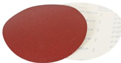
Der Klettschleifteller STK203K120 ist für die Verarbeitung von Hart- und Weichhölzern geeignet und passt für die HOLZMANN Band-Tellerschleifer BT203-914\_230V. Die Schleifteller sind mit F-Papier, antistatisch, und einer Bindung aus Vollkunstharz ausgestattet. Die Kornart ist Aluminiumoxid.
