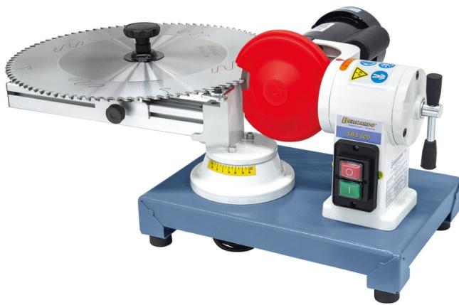
Die robuste Sägeblatt-Schärfmaschine SBS 800 dient zum Schärfen von hartmetallbestückten und CV-Sägeblättern mit einem Durchmesser von 80 - 800 mm. Durch die schwenkbare Motor-Schleifscheibeneinheit bzw. Sägeblatthalterung können die verschiedensten Verzahnungen geschliffen werden.
